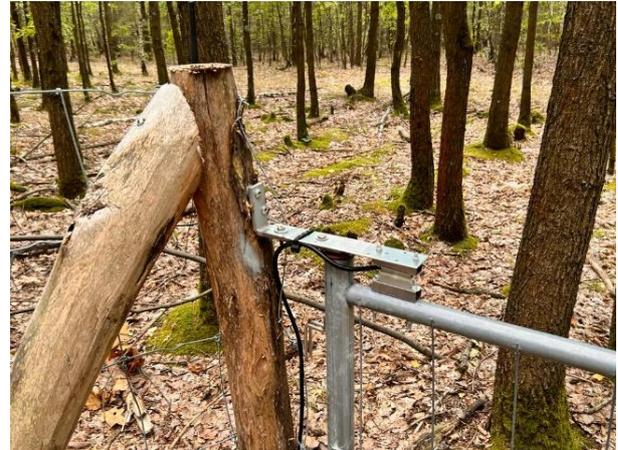
Sie können die Funktionsweise mittels Multimeter und Durchgangsprüfung testen. Messen Sie dazu den Durchgang an den offenen Kabelenden des Torsensors.
