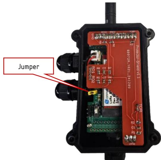
Auf dem Protaktor-Shield finden Sie für jeden Anschluss ein Schraubterminal (Grün). Nutzen Sie die entsprechenden Schraubterminals je nach Anwendungsfall.
